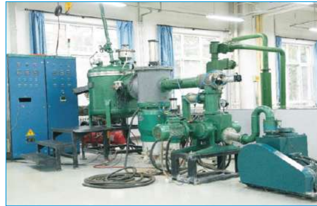
生产型真空悬浮熔炼设备 Productional type
